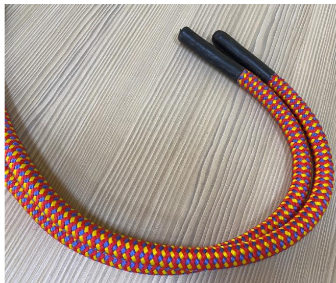
Рис. 3 – Шнуры тренажера, обработанные термообжимом
