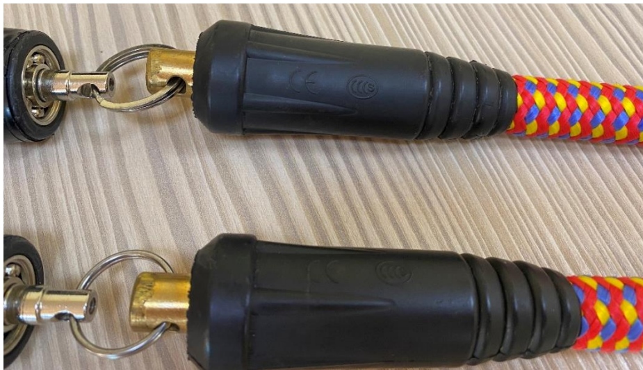
Рис. 4. Адаптеры, соединяющие шнуры и рукояти тренажера «Адаптивная скакалка»
